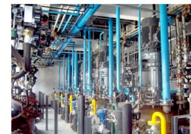
10m³、90KW、300r/min磁力反应釜
