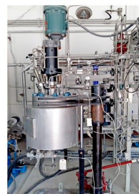
30L可移动连续聚合反应装置
