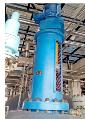
10m³自然冷却磁力反应釜
