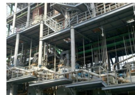
15m³、55KW、500r/min连续反应装置
