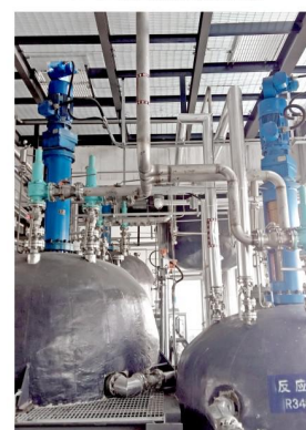
10m³复合板磁力反应釜
