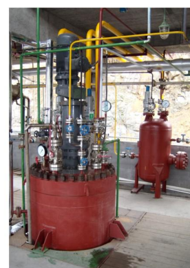
80Mpa高压加氢磁力反应釜
