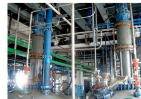
10m³搪玻璃磁力反应釜
